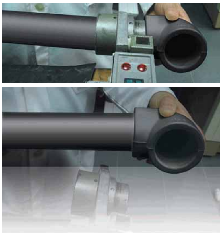
Рис. 8.2 Сварка плавлением внахлест
