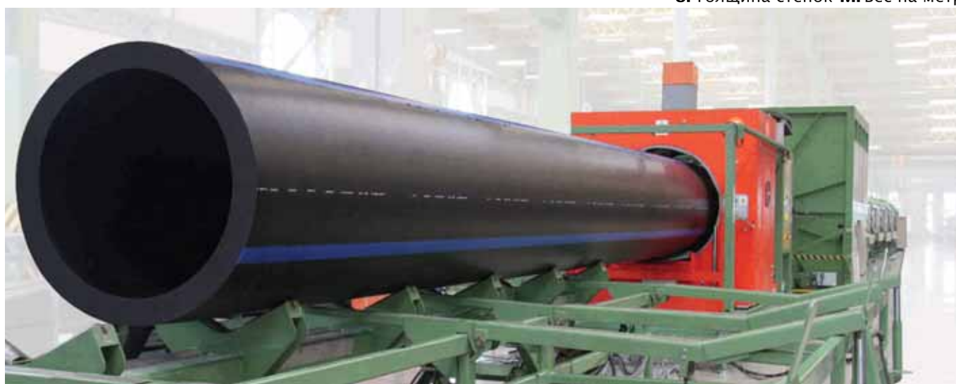
PE 100 Ø 1200 мм труба PN 16 , толщина стенки s: 109.1 мм
